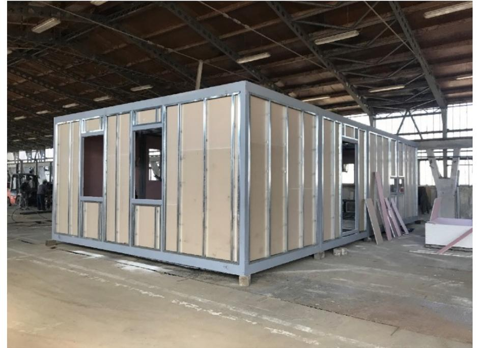
Die vor Ort Montage der Module mit einem Fertigungsgrad von fast 80% bedeutet eine deutlich geringere und kürzere Lärm- und Staubbelastung der Ausbau, als bei der herkömmlichen Technologie.
