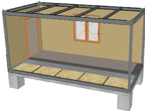
Rahmenstruktur, Bodenschichtreihenfolge + Gipskartoninnenwände (mit Fenster, Tür).
