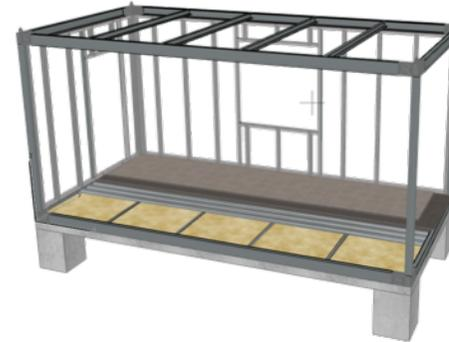
Rahmenstruktur, Bodenschichtreihenfolge + zusätzliche Stahlhalterungen zur Befestigung der Türen und Fenster sowie die Tragstruktur für die inneren Trennwände der Gipskartonplatten.
