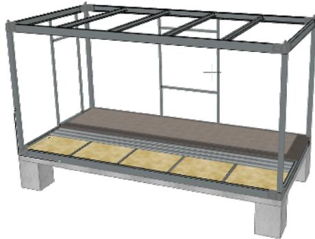
Rahmenstruktur, Bodenschichtreihenfolge + zusätzliche Stahlhalterungen zur Befestigung der Türen und Fenster
